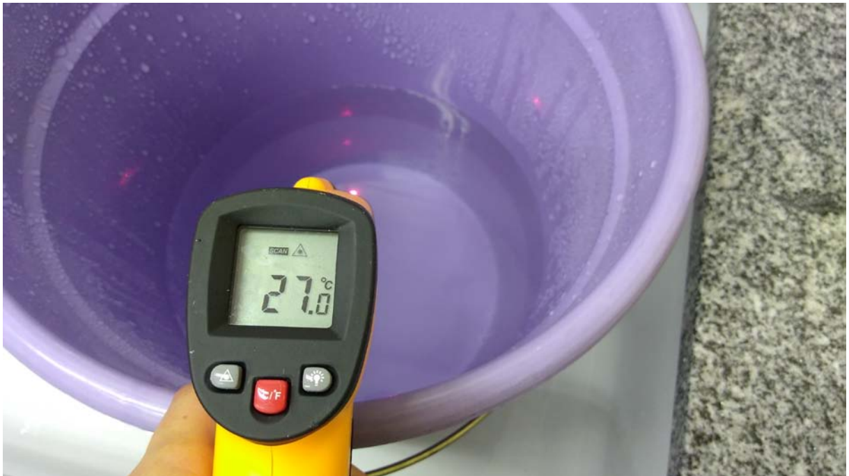
Fotografia 56 - Medição da temperatura inicial da água no berçário 1 (Fonte: Levantamento de campo realizado pelo grupo)
